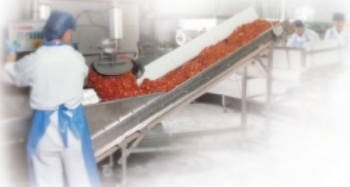
Præcisionsarbejde: På opskæringsvirksomheden i Fårvang er det installeret et standardise- ringsanlæg, der gør det muligt at styre fedtindholdet meget sikkert i bl.a. småkød.
